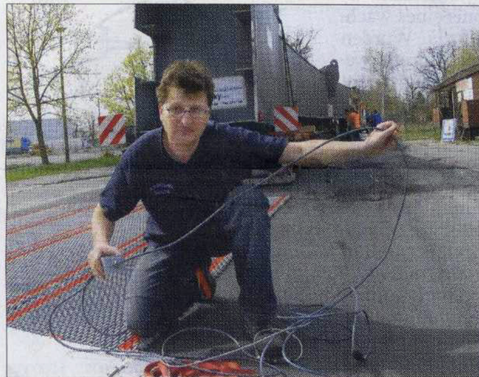
DER MANN MIT DER MOBILEN LASTWAAGE: Thomas Gollmer aus Bautzen bereitet die mobile Lastwaage vor. Jede einzelne der 15 Achsen wird gewogen.
